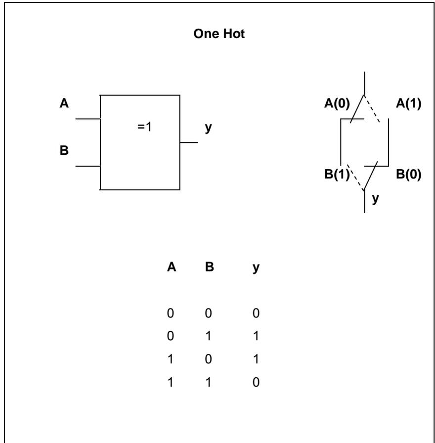
Fig. 78: One hot – truth table 2 inputs
