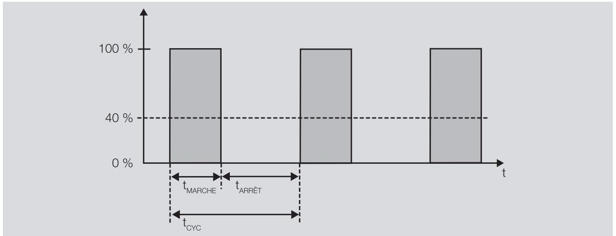
Fig. 28: Pilotage au moyen d'un rapport impulsion-pause variable
