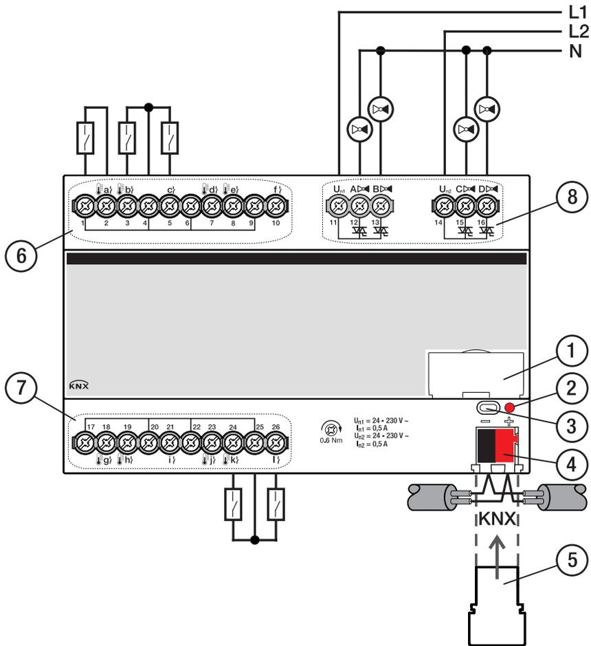
Fig. 3: Schéma de raccordement VC/S 4.1.1
