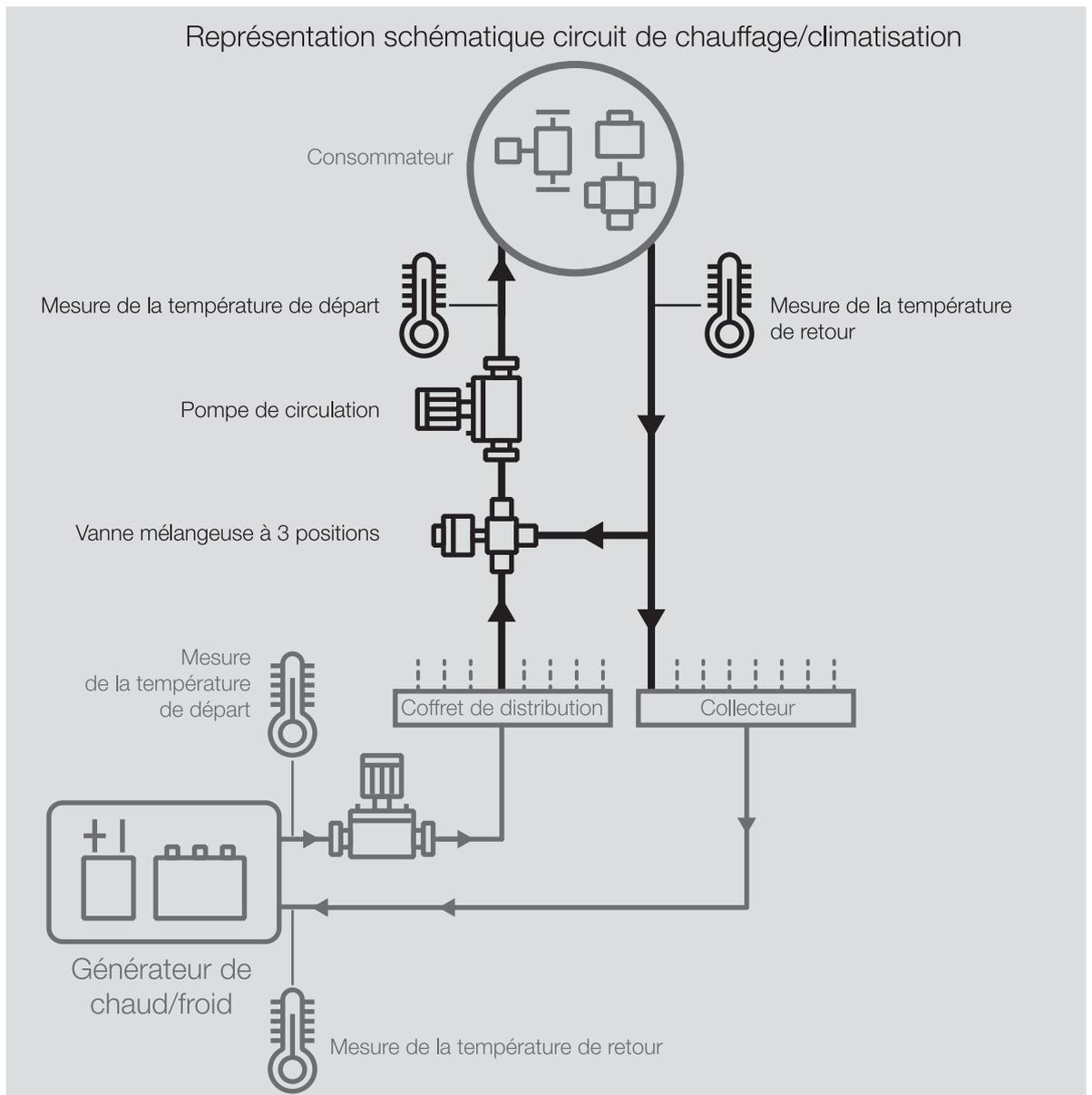
Fig. 27: Circuit de chauffage/climatisation
