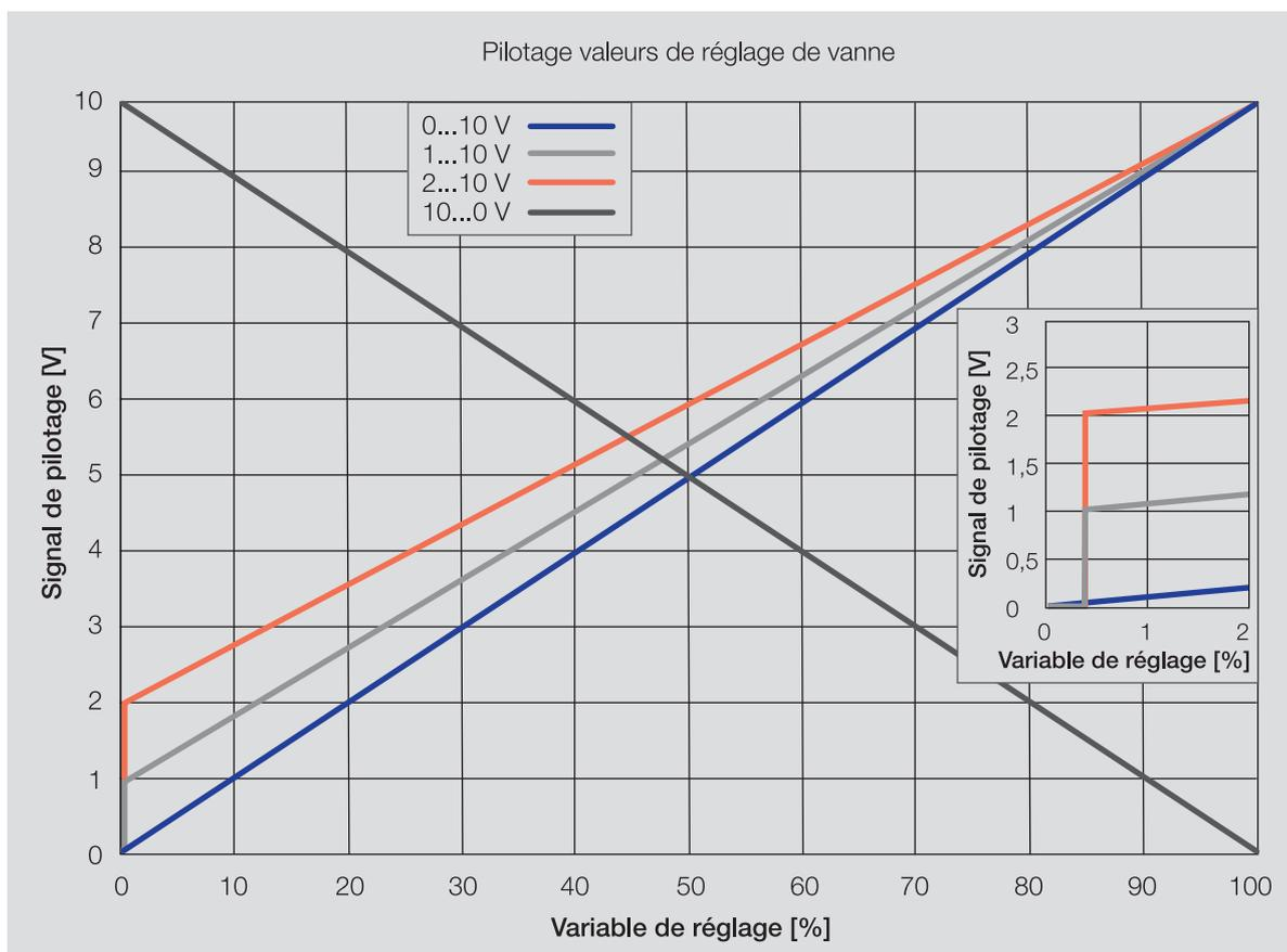
Fig. 32: Pilotage valeurs de réglage de vanne
