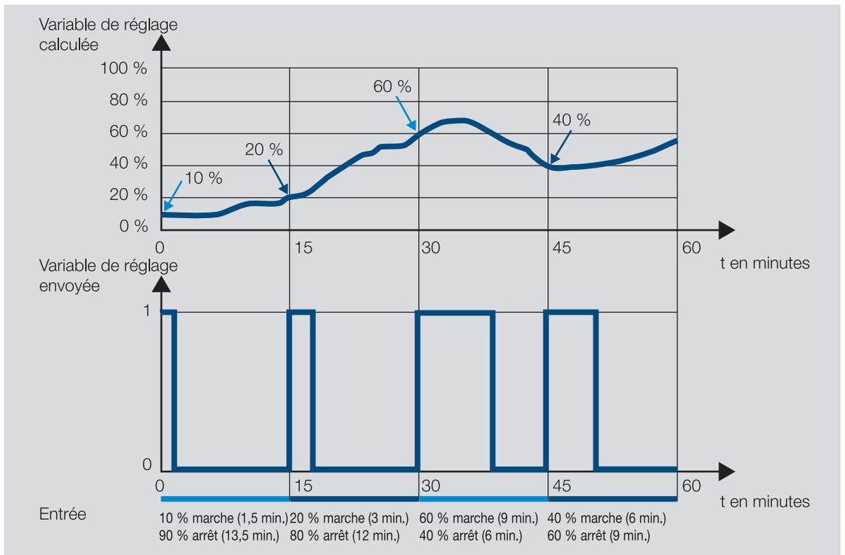
Fig. 29: Modulation de largeur d'impulsion - Exemple
