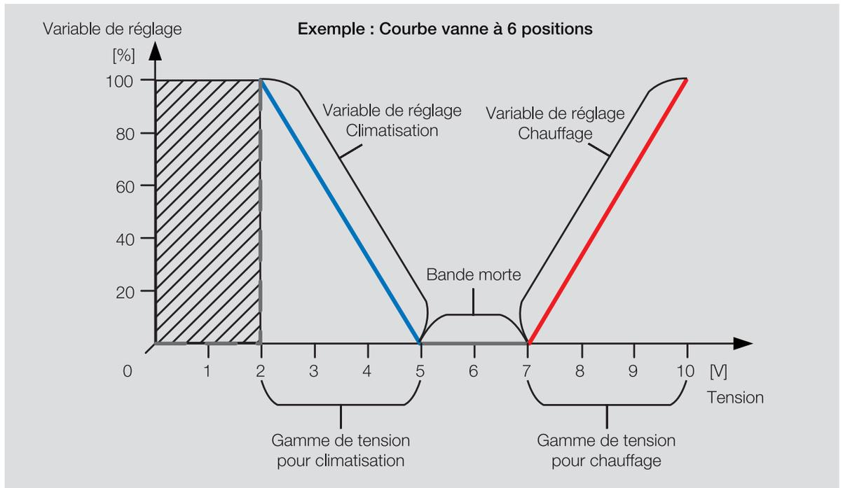
Fig. 33: Pilotage d'une vanne à 6 positions
