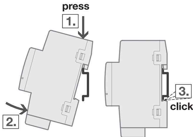
Fig. 7: Montage sur le rail
