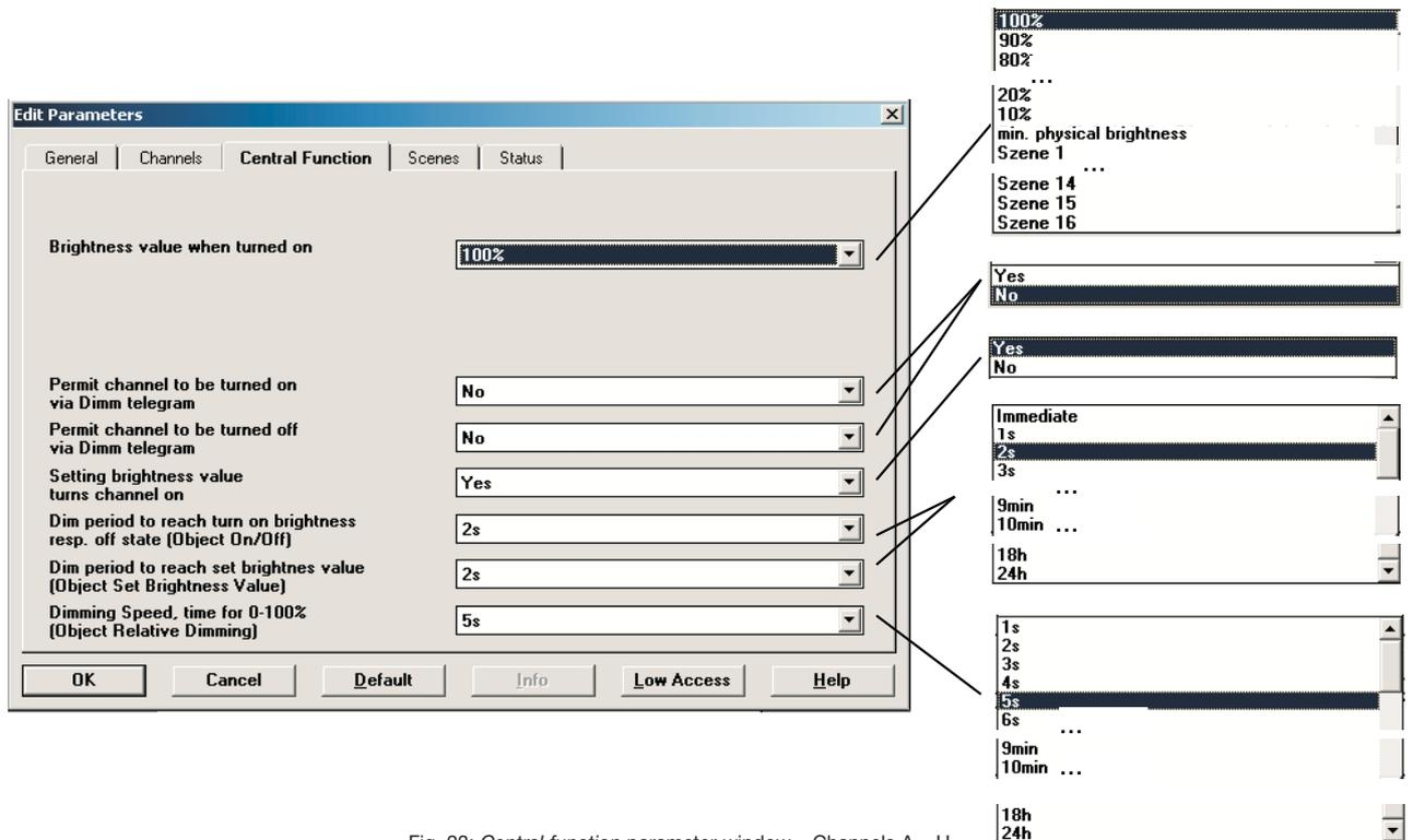
Fig. 23: *Central function* parameter window – Channels A...H
