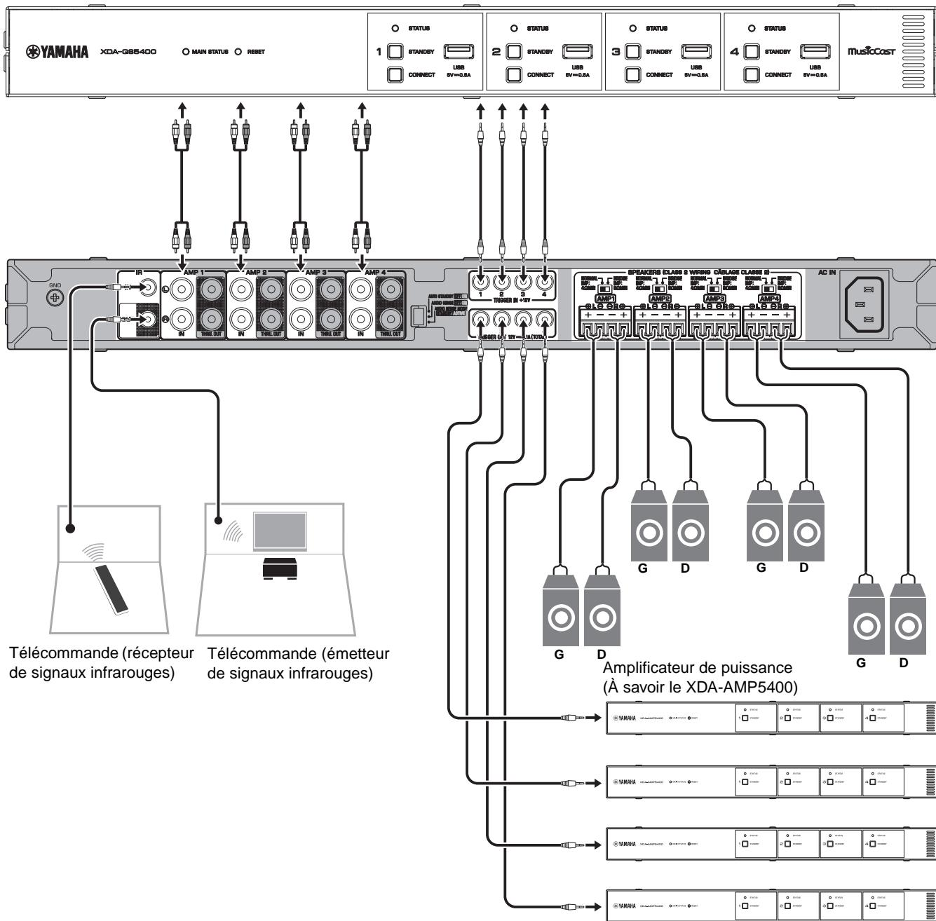
L'unité n'est pas dotée de commandes de volume. Assurez-vous de raccorder à l'unité un appareil doté d'une commande de volume (par exemple, un préamplificateur). Si vous raccordez un appareil sans commande de volume (par exemple, un lecteur CD) directement à l'unité, le volume risque d'être assourdisant et des dommages peuvent survenir au niveau de l'unité ou des enceintes.
