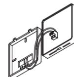
Inserte el borne en el contacto de la placa conductora.
