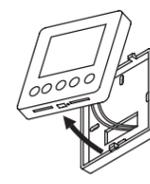
Abra y quite la parte superior de caja del borde inferior del aparato. Saque el contacto enchufable de la placa conductora.
