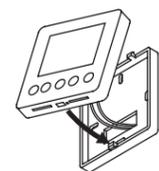
Setzen Sie die Aussparungen des Gehäuseoberteils auf die entsprechenden Rastnasen des Gehäusebodens und klappen Sie das Oberteil nach unten, bis es einrastet.
