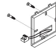
Montieren Sie den Gehäuseboden an der Wand oder auf einer UP-Dose.
