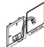
Stecken Sie die Klemme auf die Kontakte der Leiterplatte.
