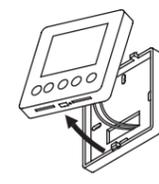
Klappen Sie das Gehäuseoberteil von der Unterkante des Gerätes nach oben weg. Ziehen Sie den Steckkontakt von der Leiterplatte ab.
